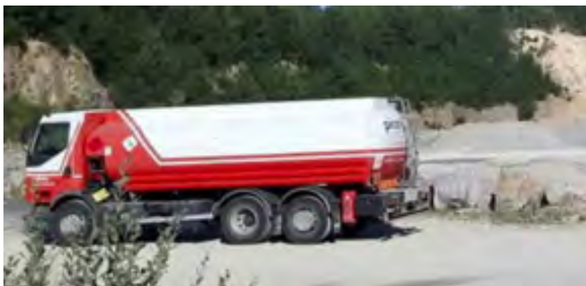
▲ Exemple de camion-citerne pour le ravitaillement des engins
